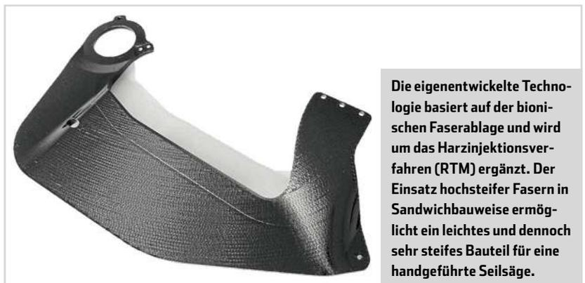
Die eigenentwickelte Technologie basiert auf der bionischen Faserablage und wird um das Harzinjektionsverfahren (RTM) ergänzt. Der Einsatz hochsteifer Fasern in Sandwichbauweise ermöglicht ein leichtes und dennoch sehr steifes Bauteil für eine handgeführte Seilsäge.
